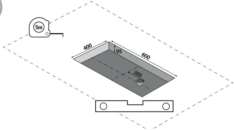
**Asegurarse de que el suelo y la plataforma (si se instala) sean capaces de soportar un peso mínimo de 800 kg.**
