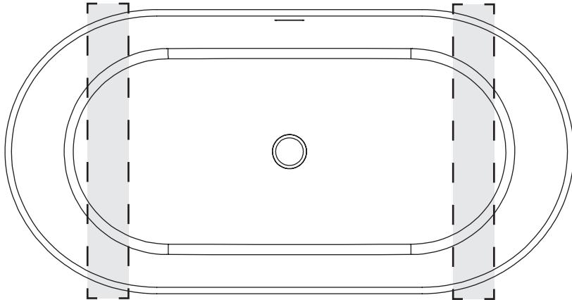
Dado que las bañeras en isla no cuentan con aperturas para revisión, deberá colocarse sobre dos viagras de madera para instalarla. A continuación se debe proceder a conectar el sifón proporcionado (rosca de 1,5 pulgadas) al sumidero. Asegúrese de que la rosca esté colocada correctamente y derecha.
