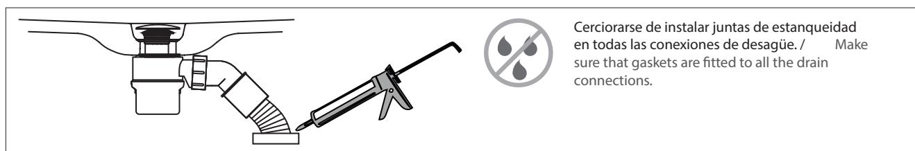
Para conectar de manera segura el sifón al sumidero se necesita un tubo flexible debido a la tirantez al descender la bañera a su posición final. Conecte el sifón al desagüe con el tubo flexible. Después, conecte el sifón al sumidero de la bañera.
