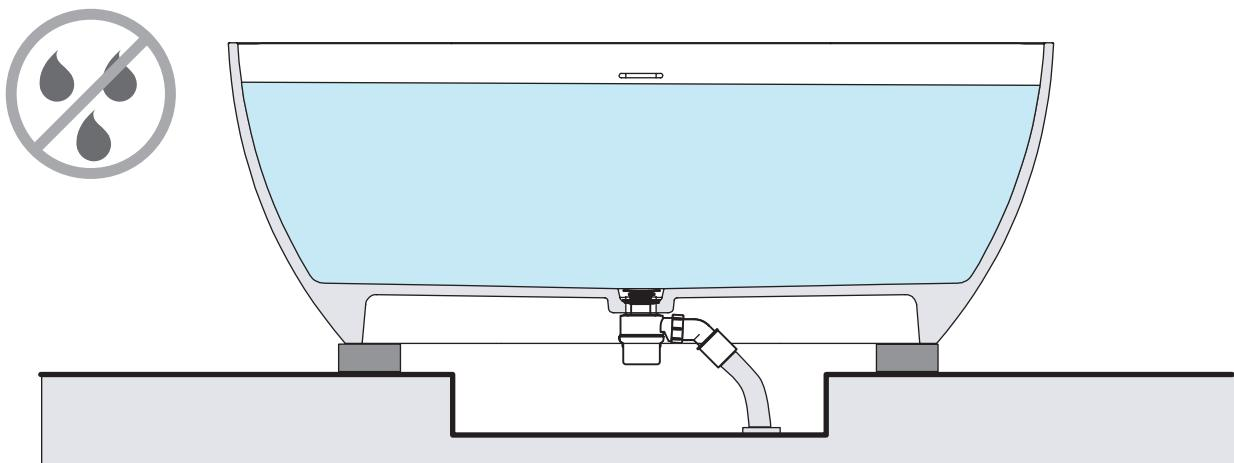
Con la ayuda de un especialista en sanitarios, proceda a abrir el grifo del agua fría y el del agua caliente e inspeccionar todas las conexiones para comprobar que no haya fugas. Llenar la bañera de agua e inspeccionar las conexiones del desagüe para comprobar que no haya fugas.
